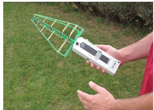
Par exemple : l'appareil HF 38B (800 Mhz –2500 Mhz) GIGAHERTZ SOLUTIONS
